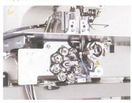
電子サイクル用 MIJ-200 ミシンまたはボビンチェッカーからの信号 により自動的に下糸を交換します。
