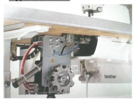
本縫い自動糸切ミシン用 DB100 ミシンまたはボビンチェッカーからの信号 により自動的に下糸を交換します。
